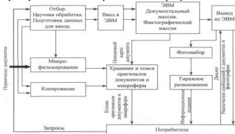
Рисунок 1 - Вариант схемы автоматизированной информационной системы
