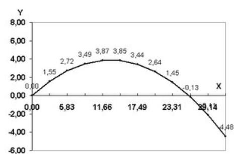
Исследуем модель и определим с заданной точностью 0,1 градуса значения диапазона изменений угла, которые обеспечивают попадание в площадку, находящуюся на расстоянии 25 м и длиной 2 м, при заданной начальной скорости 17 м/с. Воспользуемся для этого методом *Подбор параметра*.
