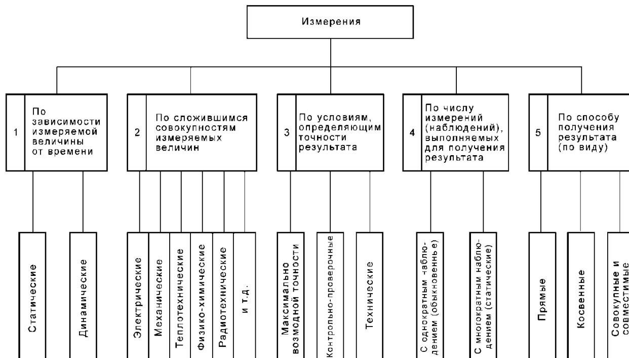
Рисунок 1 – Классификация средств измерения
