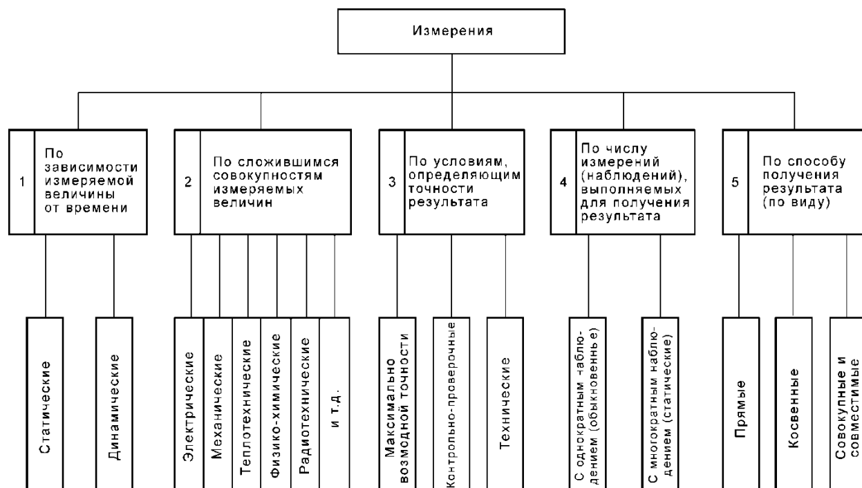
Рисунок 1 – Классификация средств измерения
