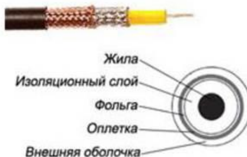
Рисунок 1. Конструкция коаксиального кабеля
