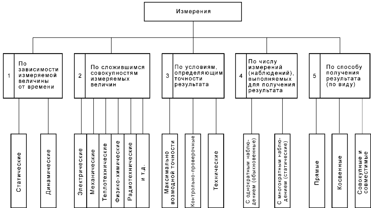
Рисунок 1 – Классификация средств измерения
