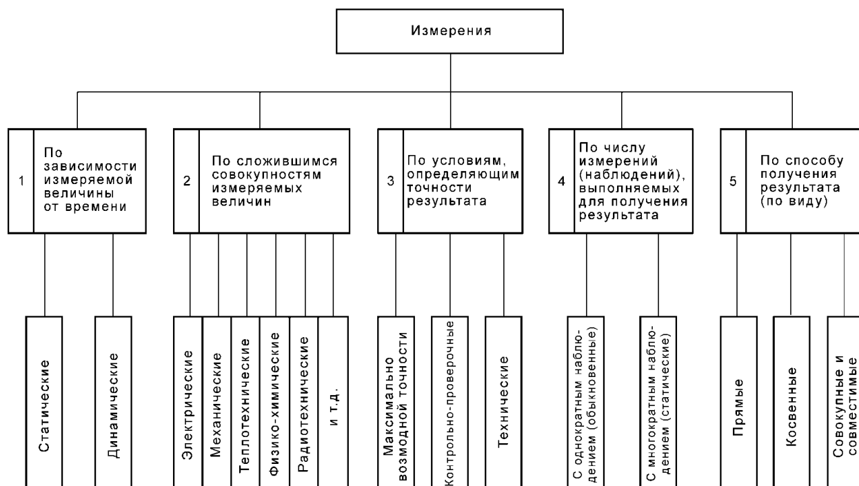
Рисунок 1 – Классификация средств измерения
