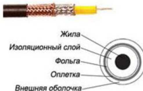
Рисунок 1. Конструкция коаксиального кабеля
