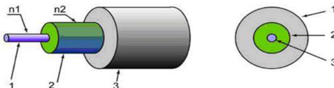
Рисунок 5. Структура оптоволоконного кабеля: 1 – сердцевина с показателем преломления n_1 ; 2 – отражающая оболочка с показателем преломления n_2 , n_1 > n_2 ; 3 – защитное покрытие.
