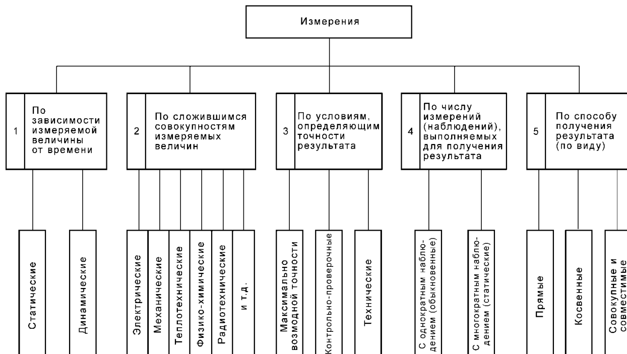
Рисунок 1 – Классификация средств измерения
