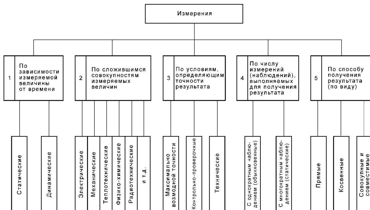
Рисунок 1 – Классификация средств измерения
