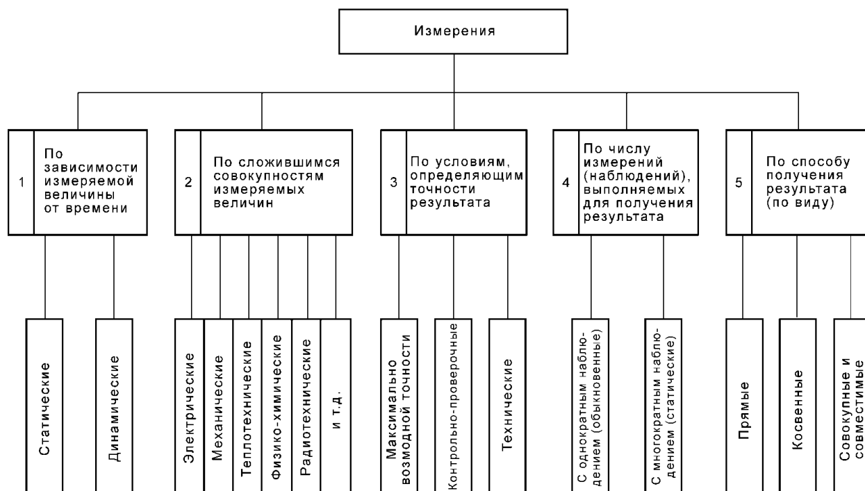
Рисунок 1 – Классификация средств измерения
