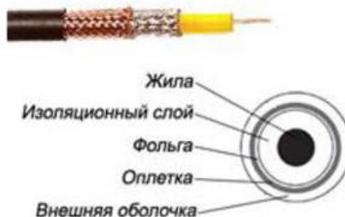
**Рисунок 1.** Конструкция коаксиального кабеля
