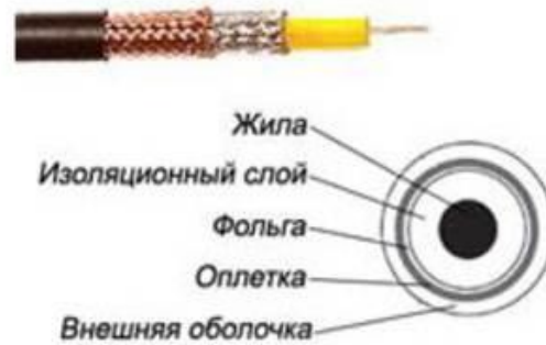
Рисунок 1. Конструкция коаксиального кабеля
