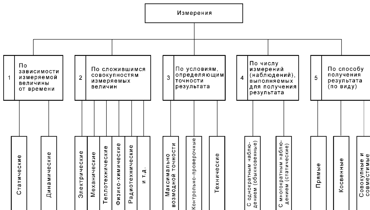
Рисунок 1 – Классификация средств измерения
