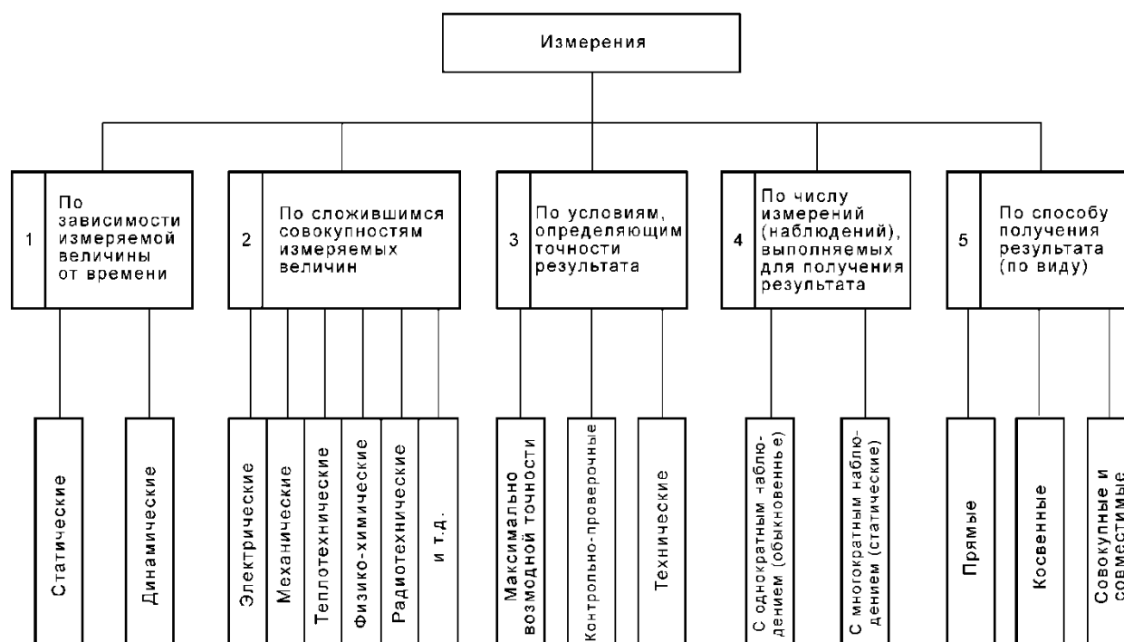
Рисунок 1 – Классификация средств измерения
