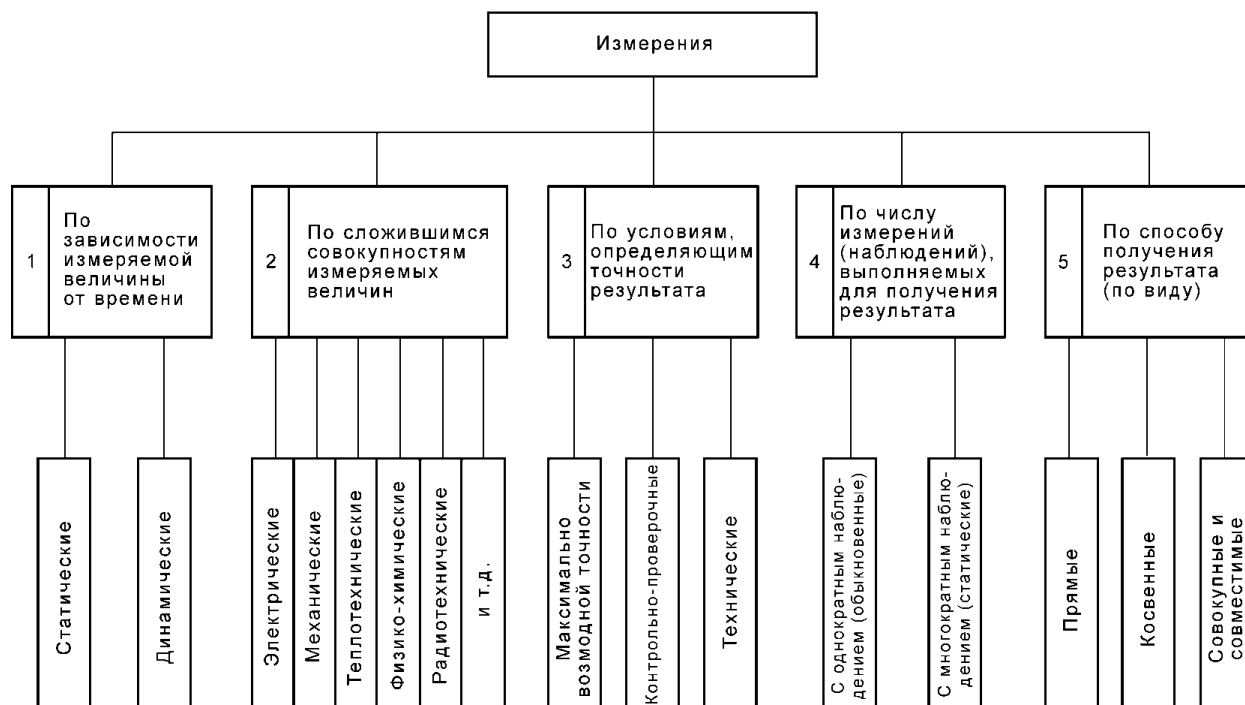
Рисунок 1 – Классификация средств измерения
