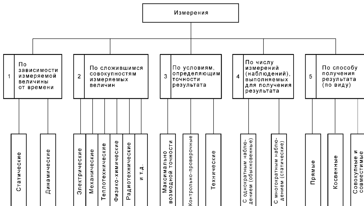
Рисунок 1 – Классификация средств измерения
